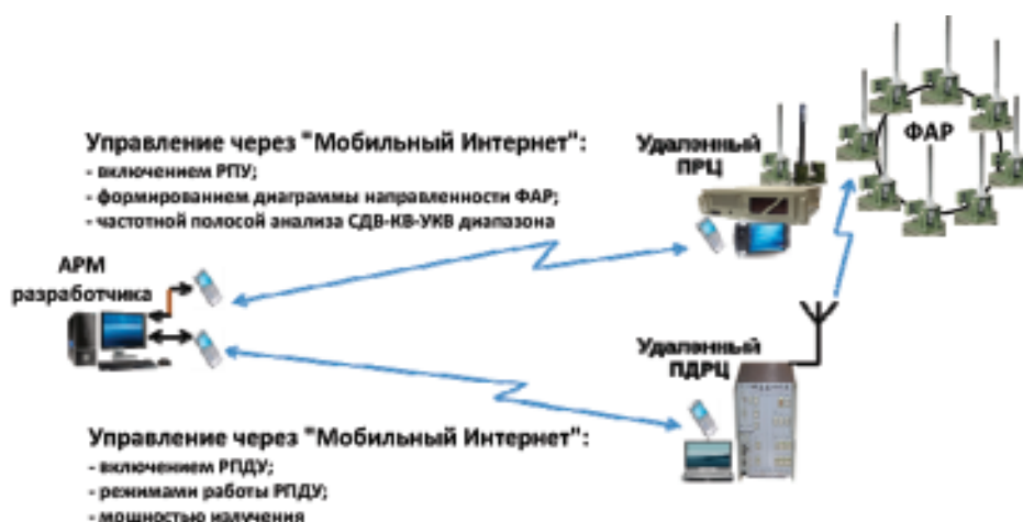
Рис. 5. Структурная схема реализации комплекса технологического оборудования: ПРЦ — приемный радиоцентр; ПДРЦ — передающий радиоцентр; ФАР — фазированная антенная решетка
