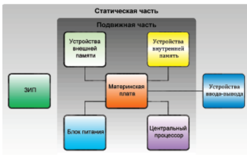
Рис. 1. Структурная схема наклонного стенда технического обслуживания и ремонта персонального компьютера
